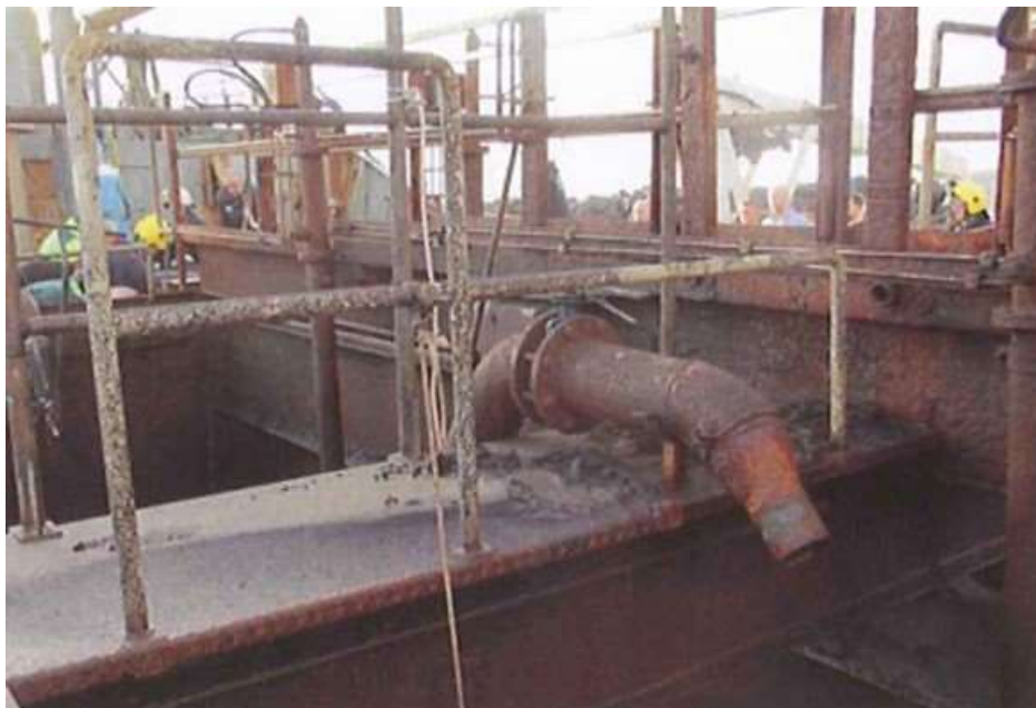
Mynd 1 Myndin sýnir vettvang og sjölögnina sem stúturinn losnaði af
